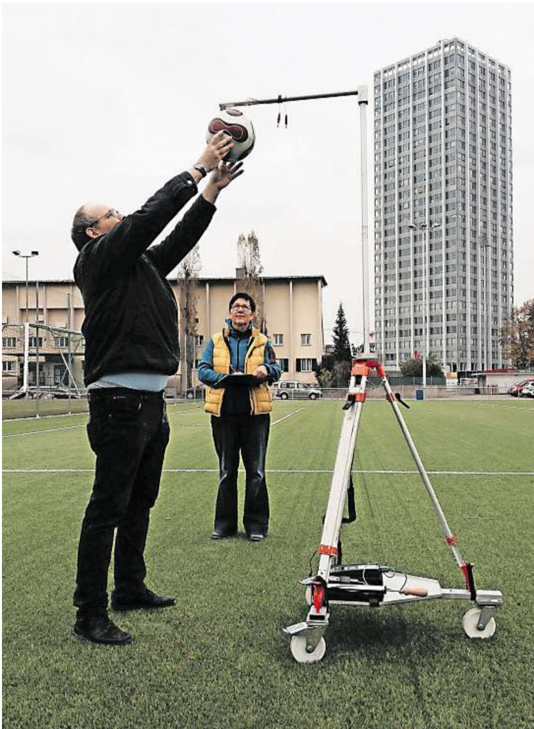
So unspektakulär sieht ein Test nach Fifa-Norm aus: Prüfungsleiter Thomas Hartmann lässt einen Ball auf den neuen Kunstrasen des FCW fallen, Karin Glasze-Kolitzus notiert die Werte des Messgeräts.
