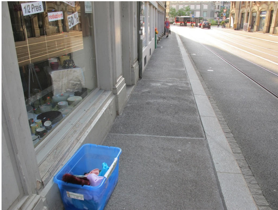
Bild 13: Linsebühlstrasse, St. Gallen: eindeutig zu schmales Trottoir; zwei Kinderwagen können hier nicht queren
