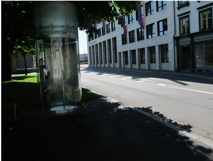
Bild 20: Querung Elisabethenstrasse; Basel: Diese Telefonzelle ist sehr ungünstig positioniert, da sie die Sicht zwischen FussgängerInnen und FahrzeuglenkerInnen versperrt. Direkt rechts neben dem Bildrand befindet sich der Fussgängerstreifen.
